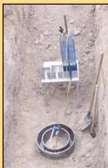
Photo 3.1 : Exemple d'essai d'infiltration au double anneau ouvert
